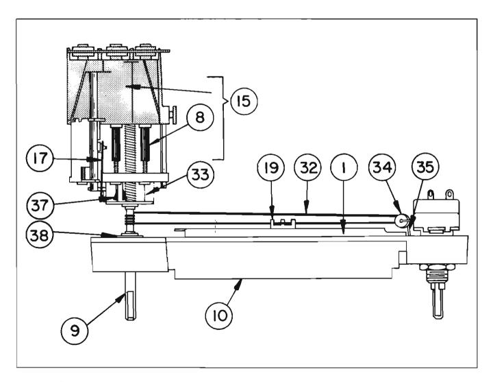
Figure 36 - TUNER PARTS LAYOUT AND DIAL CORD VIEW - ALL MANUAL TUNED RADIO
