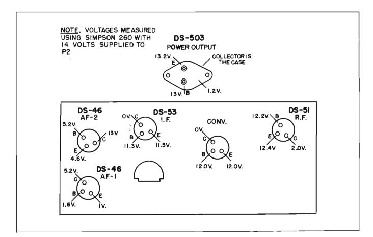
Figure 28 - VOLTAGE CHART - ALL MANUAL TUNED RADIO
