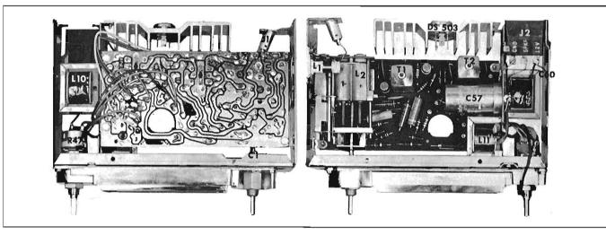
Figure 39 - CHEVELLE PARTS LAYOUT TUNER VIEW - 986201 - RADIO
